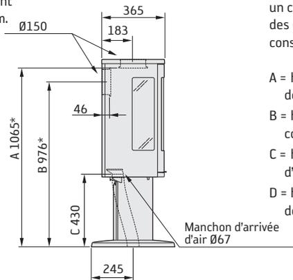
La distance minimale devant l'ouverture du poêle à un élément de construction ou d'ameublement inflammable doit être de 1,1 mètre.
